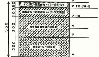
車道 剛式アスファルトコンクリート舗装 (改質II型・70型)
