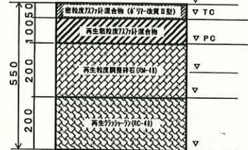
車道 アスファルトコンクリート舗装 (40型)
