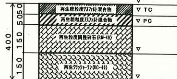
車道 アスファルトコンクリート舗装 (40型)
